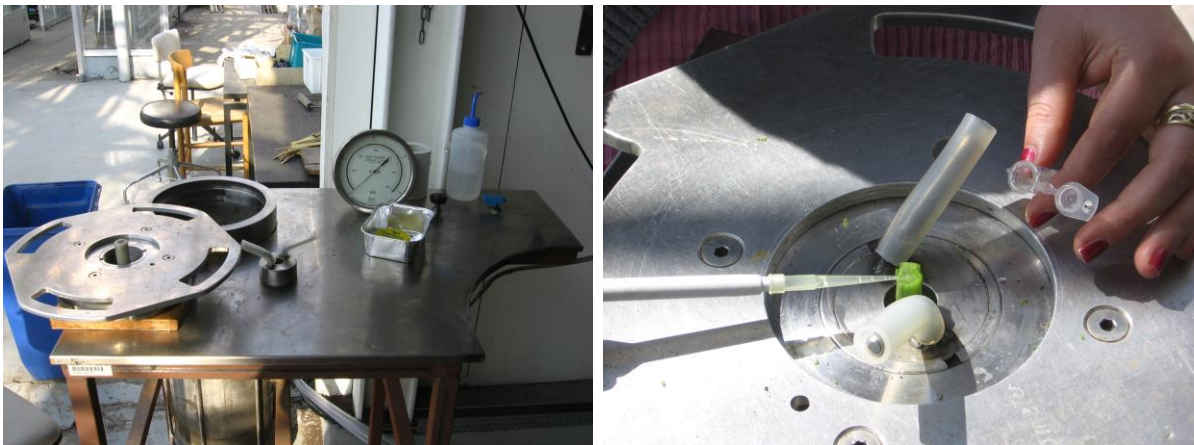
Slika 4.6 Komora pod pritiskom korišćena za sakupljanje ksilemskog soka
