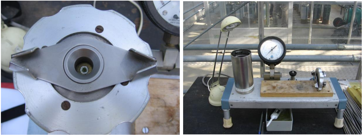
Slika 4.5 Komora pod pritiskom za merenje vodnog potencijala ( \Psi_1 )
