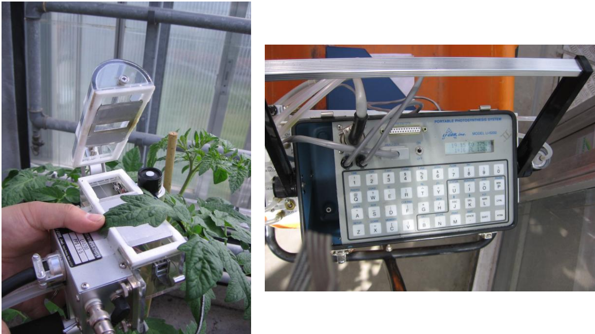
Slika 4.4 Sistem za merenje fotosinteze
